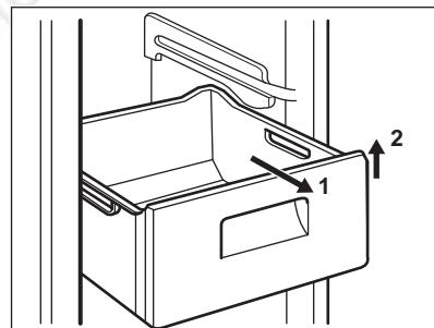
Вставляя корзину в морозильную камеру, слегка приподнимите ее переднюю часть. Преодолев стопоры, задвиньте корзину до упора.
