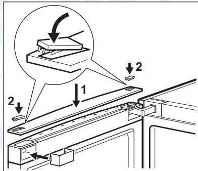
**20.** Снимите ограничитель нижней дверцы и установите его на противоположной стороне.
