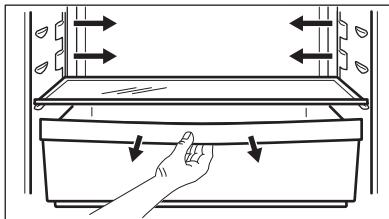
Ящик предназначен для хранения таких свежих продуктов, как мясо, рыба, морепродукты, поскольку температура в нем ниже, чем в остальной части холодильника.
